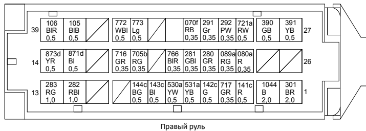
ZZ01 Соединение проводки правой передней двери
